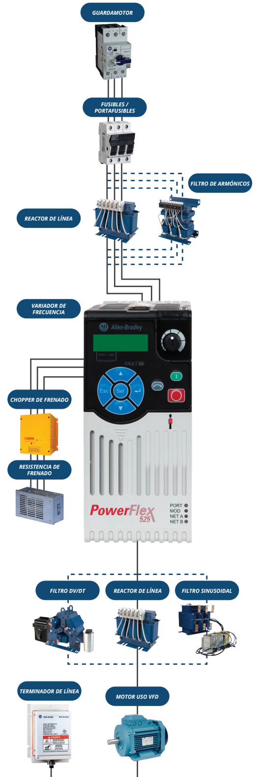
Sistema típico de variador PowerFlex 525 para un máximo aprovechamiento de la energía y protección.
