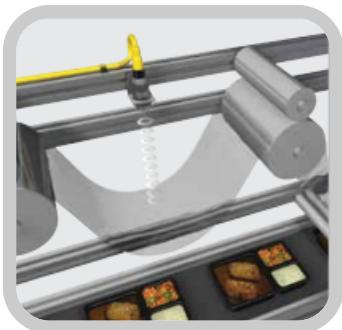
**Detección de posición de película** - El 873M ultrasónico comprueba la constante alimentación de película al tiempo que monitorea su tensión.
